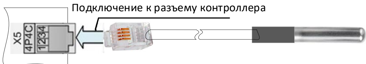
Рисунок 2. Схема подключения ДТ-LM-RJ IP65 (влагозащитное исполнение)
