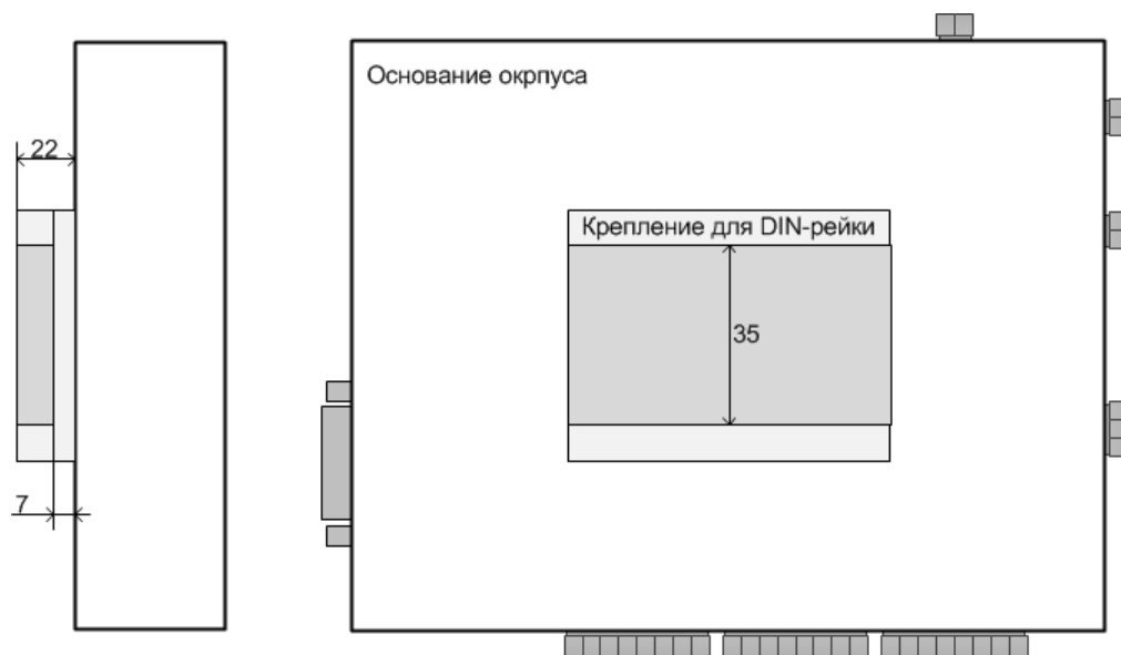
Рис. 27. Основание корпуса изделия с креплением на DIN-рейку
