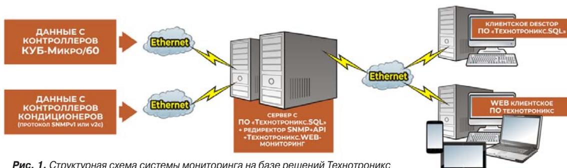
Рис. 1. Структурная схема системы мониторинга на базе решений Технотроникс
