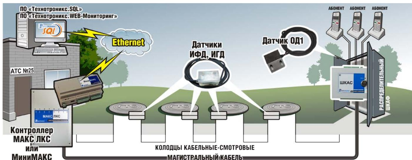
**Контроллер МАКС ЛКС** - универсальное устройство для комплексного контроля всего многообразия линейно-кабельных сооружений: магистрального кабеля, распределительных кабелей, распределительных шкафов, колодцев кабельных смотровых (ККС).
