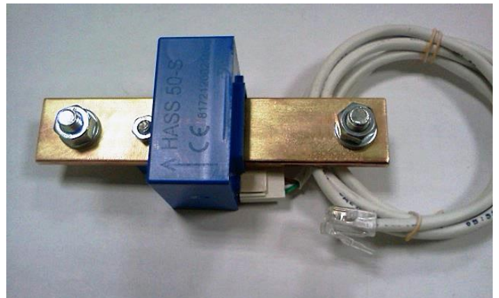
Рис. 4. Аксессуары для монтажа АБ: клеммы – переходники, кабель Н., датчик тока с кабелем Т.
