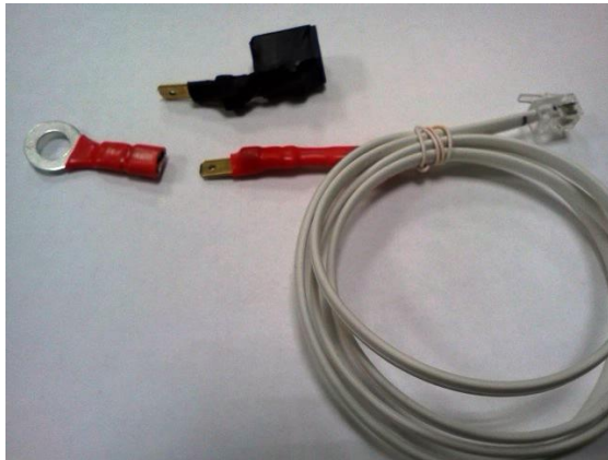
Рис. 4. Аксессуары для монтажа АБ: клеммы – переходники, кабель Н., датчик тока с кабелем Т.
