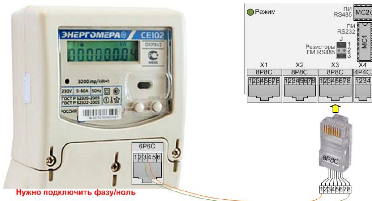
Рис.56. Схема подключения электросчетчика Энергомера CE102 S7 *А*
