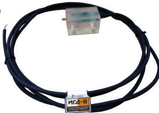
Датчик ИГД-В полностью идентичен в плане протокола обмена с фотодатчиками ИФД, устанавливаемыми с целью фиксации вскрытия люка ККС. При совместном использовании датчиков в колодце, ИГД-В подключается в единый двухпроводный канал обмена данными с ИФД и различается только при прописывании в базе данных ПО «Технотроникс.SQL». В качестве контроллера, принимающего данные от датчиков, используется наш бессменный МАКС ЛКС (или МиниМАКС), размещаемый на АТС.
