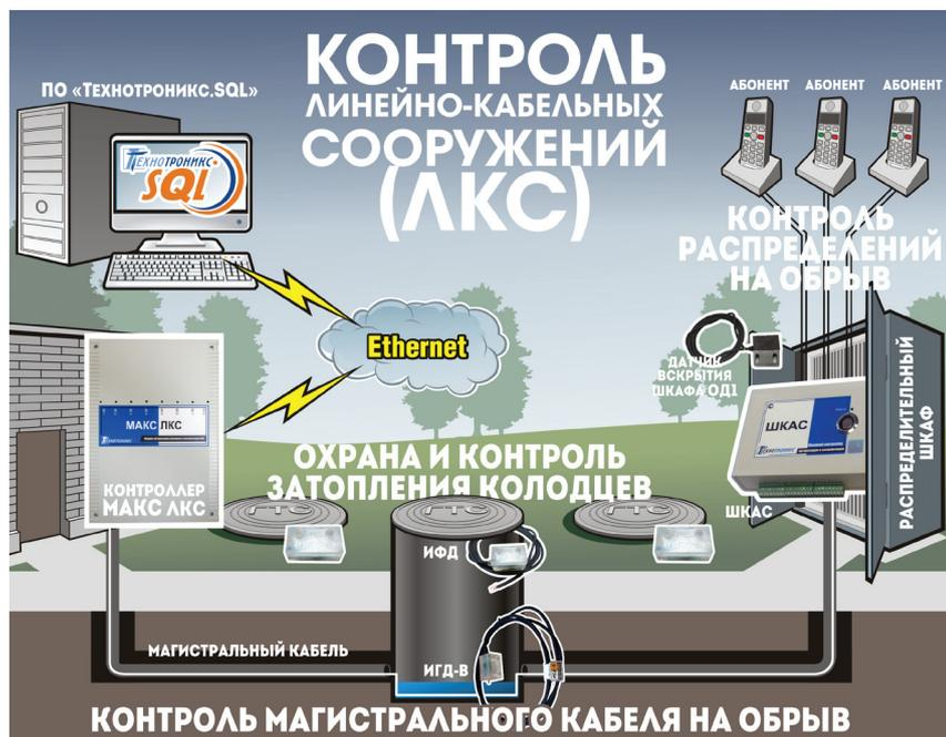
Рис. 1. Функционально-структурная схема системы контроля ЛКС.
