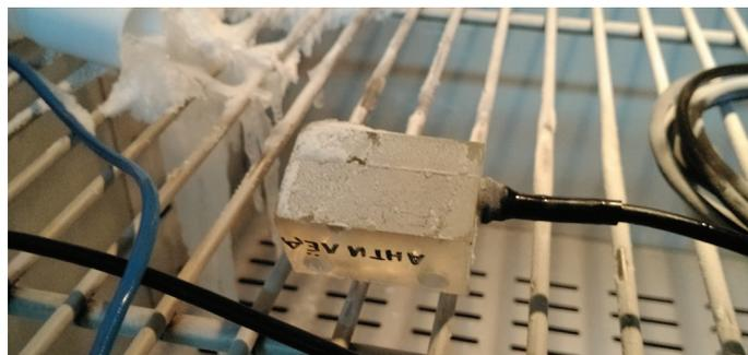
Фото 3-4: Температура понижается, начинает нагнетаться влажный воздух. Обледеневший датчик ИФД продолжает работать вместе с контроллером.
