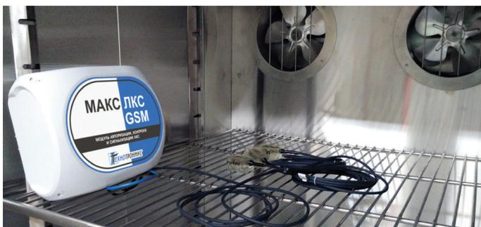
Фото 2. Испытания начались! Герметичные контроллер МАКС ЛКС/GSM и датчики вскрытия ИФД помещены в термо-барокамеру.
