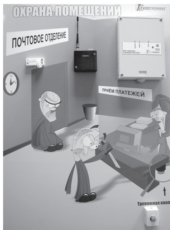
Фото 1. Демонстрационный стенд с оборудованием охраны: БИК-POST, тревожная кнопка, GSM-модем.
