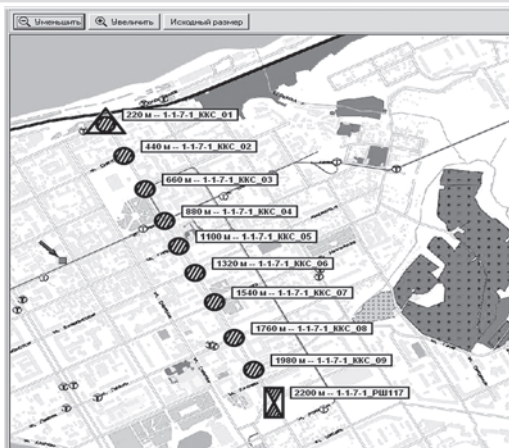
Рис.1. Подсистема “Карты”. Трасса магистрального кабеля от АТС до РШ с разметкой расположения ККС.
