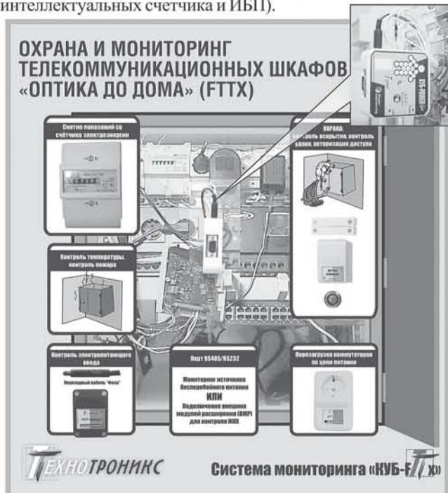
*Фото 1, 2. Система мониторинга шкафов FTTB на базе контроллера КУБ-POWERlight: контроль вскрытия, вибрации, авторизация доступа, контроль и измерение питания, контроль температуры и пожара, перезапуск зависших коммутаторов, мониторинг ИБП или подключение всей линейки ВМР при соответствующей «програмке»*
