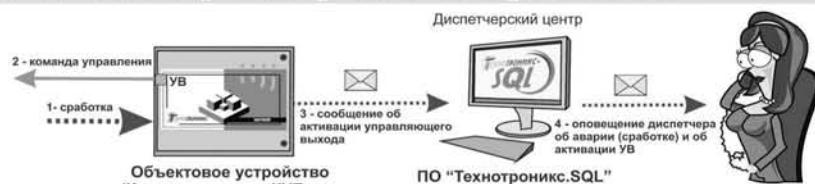
Рис. 1. Механизм управления на уровне локальной автоматики
