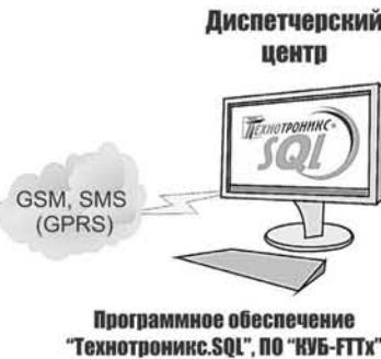
Рис. 3. Система охраны объектов PON на базе нового GSM-контроллера
