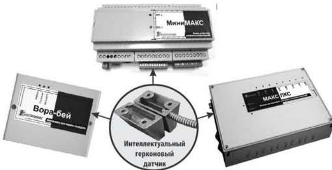
Рис. 2. Варианты аппаратной организации системы. ИГД и контроллеры, с которыми они могут работать
