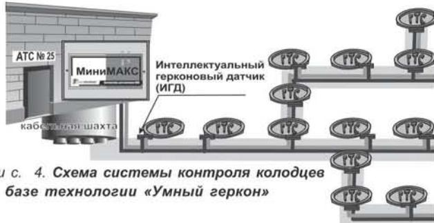
Рис. 4. Схема системы контроля колодцев на базе технологии «Умный геркон»
