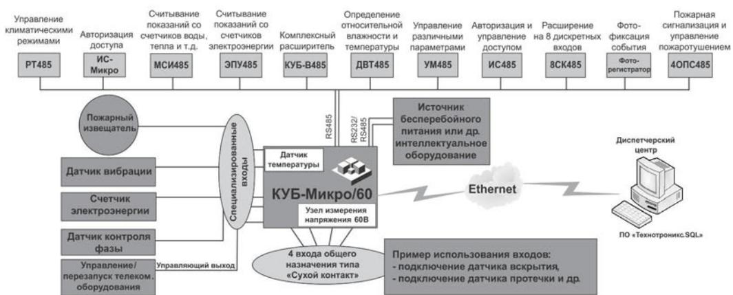
Рис. 1. Функциональная схема системы мониторинга на базе КУБ-Микро/60
