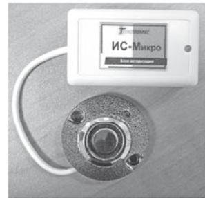
Принцип работы устройства прост: пользователь вставляет ключ в ЧИП-считыватель, микроконтроллер модуля сравнивает код ключа с одной из 20 разрешенных комбинаций, и в случае, если ключ «родной», объект снимается с охраны, и монтер может спокойно открывать дверь.
