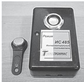
(запись разрешенных ключей в память устройства производится как автономно, на объекте, так и дистанционно, из ДЦ – в режимах, аналогичных ИС485). При совпадении считанной комбинации с одной из разрешенных, выдается команда на управление электрозамком. Одновременно любой считанный код ключа передается в ДЦ.
