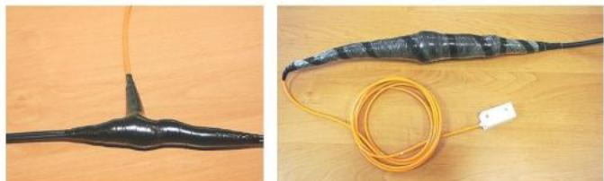
Внешний вид герметичных соединений датчиков с кабелями типа ПРППМ и типа ТПП
