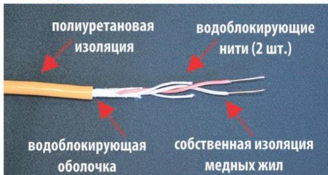
Схема герметизации кабеля ИГД
