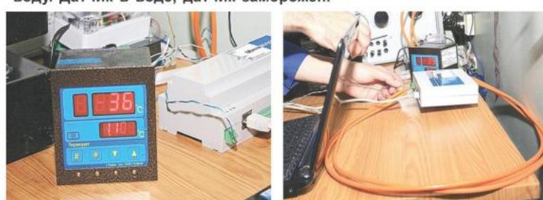
Тестирование работы ИГД, находящихся в термобарокамере, при разных температурах. Датчики подключены к контроллеру Воработ-бей (ВБ1), датчики подключены к контроллеру МиниМАКС.
