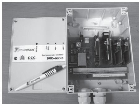
Выносные модули расширения (BMP) позволяют подключить не все функции разом, а только необходимые, и не через дополнительные каналы связи, а по единственному выделенному (сами они подключаются к БИК-Техно по интерфейсу RS485 или как датчики типа «сухой контакт»), что приводит к значительному удешевлению при расчетах.
