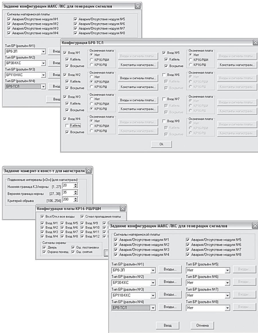
Устройство МАКС ЛКС является своеобразной «измерительной лабораторией», непрерывно измеряющей напряжение питания модулей, сопротивление и емкость контролируемых кабелей. Все эти величины передаются в центр, где обработка этих данных полностью возложена на программное обеспечение.
