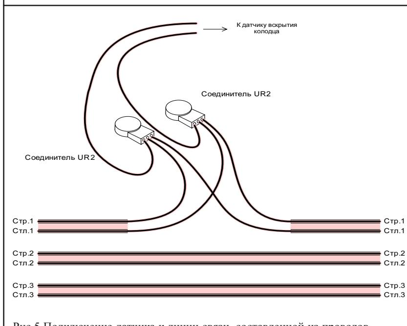
Рис.5 Подключение датчика к линии связи, составленной из проводов
