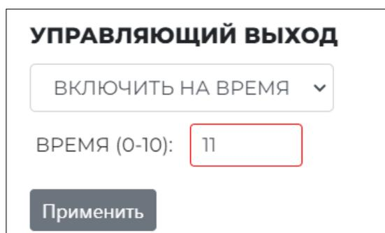
Рис. 28 Ввод времени для включения на время
